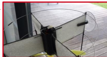
Exemple de système d'accroche du drone (ventouse sur verre).
