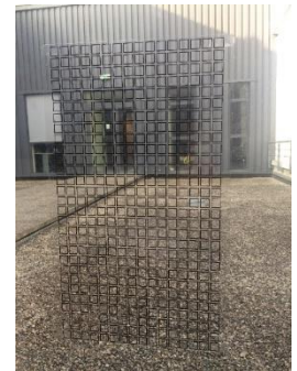
Echantillon de FSS avec motif boucle imprimée sur substrat souple PET.
